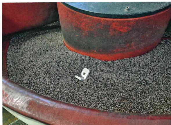
Abb. 5: Letzter Arbeitsschritt nach dem Beschichten, Verdichten der Silbergraphitoberfläche durch einen sogenannten Kugelpolierschritt im Rundtrogvibrator
