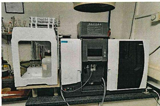
*Analysetechnik (AAS) für die Bestimmung von Schwermetallen im Abwasser wurde 2021 komplett erneuert*
