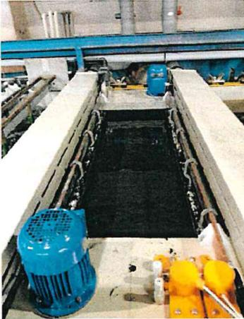
Übernahme eines patentierten Beschichtungsverfahrens von der Fa. Siemens. Bei dem Verfahren handelt es um die Oberfläche Silbergraphit AgC. Mit diesem Verfahren veredeln wir spezielle Bauteile der Elektrotechnik. Bei Silbergraphit wird Graphit als „Schmierstoff“ in die Oberfläche mit eingebaut. Das verringert den Verschleiß der Bauteile, die vorwiegend im Hochstrombereich eingesetzt werden, erheblich. Die erforderlichen Änderungen an den Anlagen sind gem. BImSchG angezeigt bzw. genehmigt.
