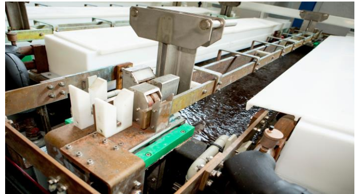
Warenträger in einem Beschichtungsbad
